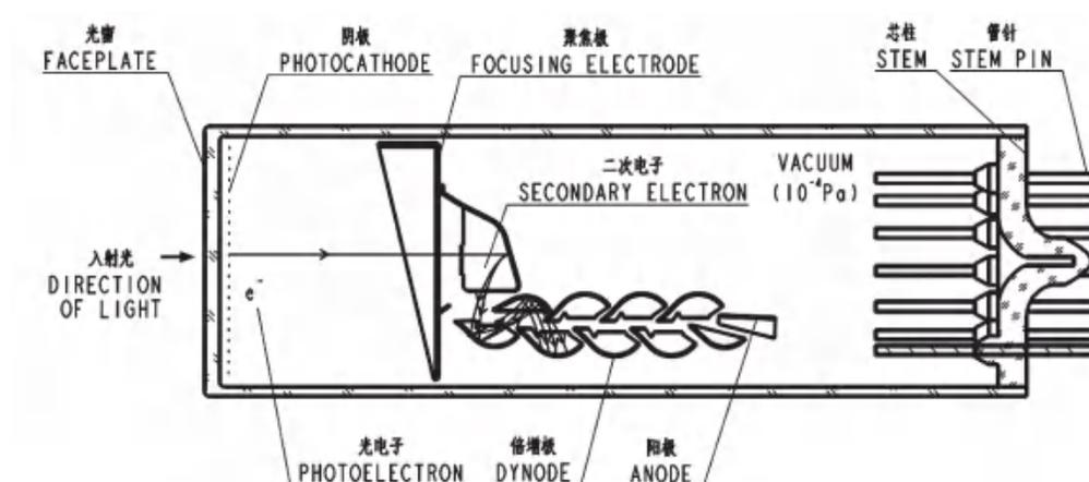
打拿极型光电倍增管结构原理图
