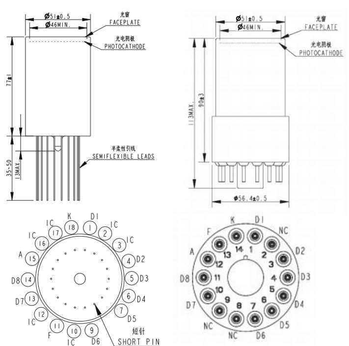
N4022型光电倍增管外型结构及管脚定义图
